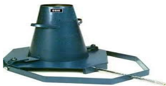
Fig no: 4.1 - SLUMP test apparatus
